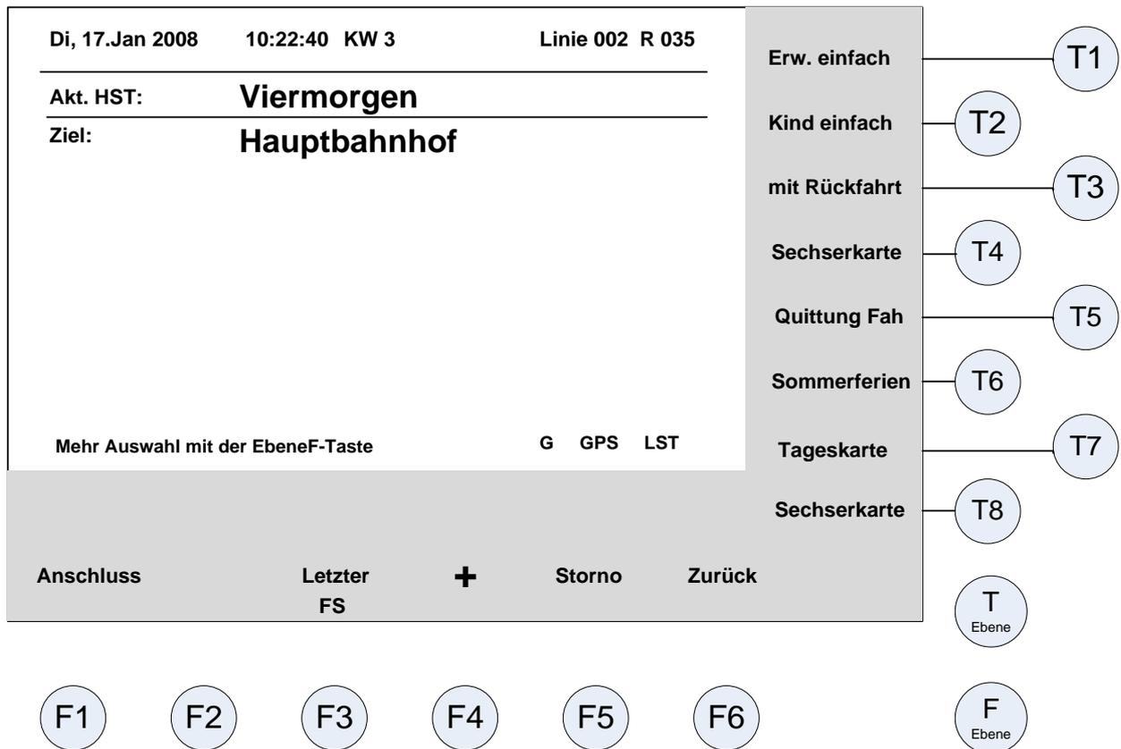
Durch Drücken der Softkey-Taste „Anschluss“ öffnet sich für den Fahrer der Dialog zur Eingabe bzw. zur Auswahl der gewünschten Umsteigehaltestelle des Fahrgastes.
