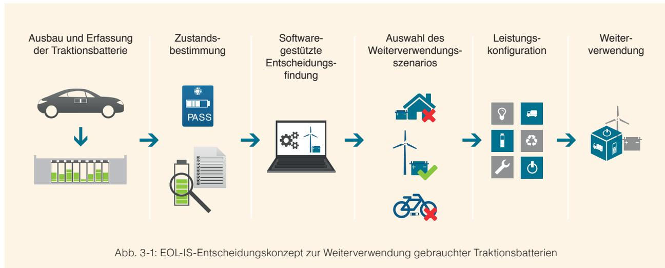
Abb. 3-1: EOL-IS-Entscheidungskonzept zur Weiterverwendung gebrauchter Traktionsbatterien
